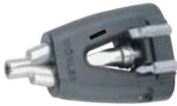
**Multi-Key** gut in der Tasche zu tragen, Spezial Hohlvierkantkonus 6-11 mm, Vollvierkant 6-10 mm, 2 Schlitz-Schraubendreher, 2 Kreuzschlitz-Schraubendreher, Zweibartschlüssel für Revisionsöffnungen, Flügelmutterschlitz, 160 g leicht WMK-001W20 **54,90**
